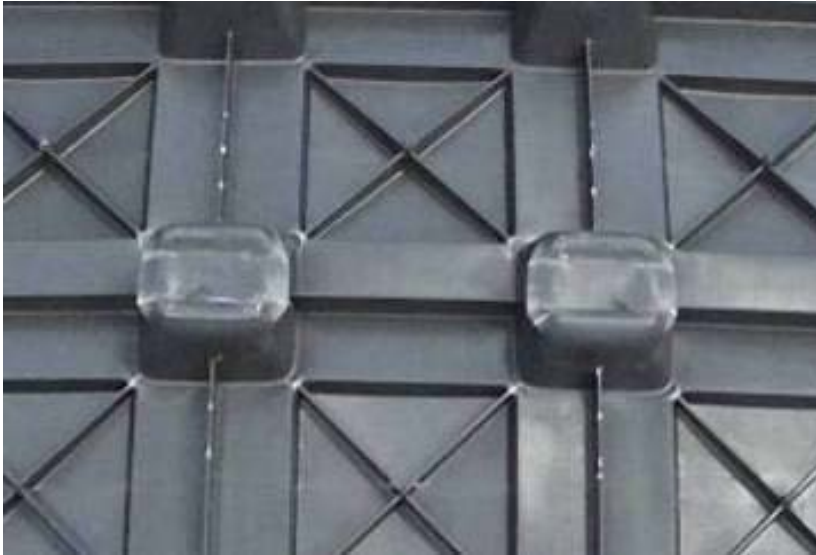
Resim 8: DEFENDER numunesi testinin sonunda kırılmış ürün detayı (serbest)
