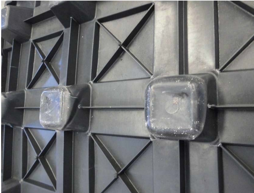
Resim 4: DEFENDER (sarılmış) numunesi testinin sonunda kırılmış ürün detayı
