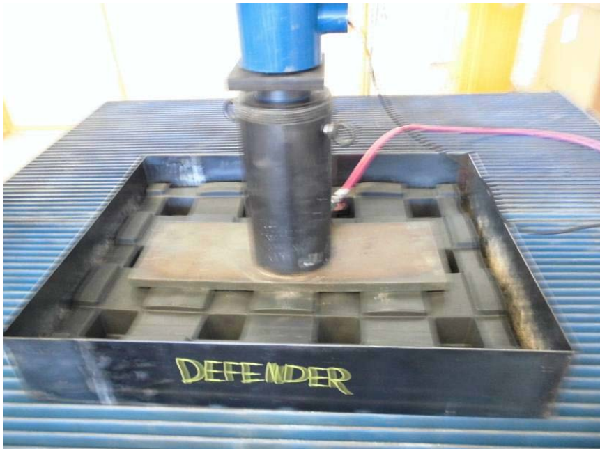
Resim 2: DEFENDER'a önceden belirlenen yükün uygulanması (sınırlanmış)
