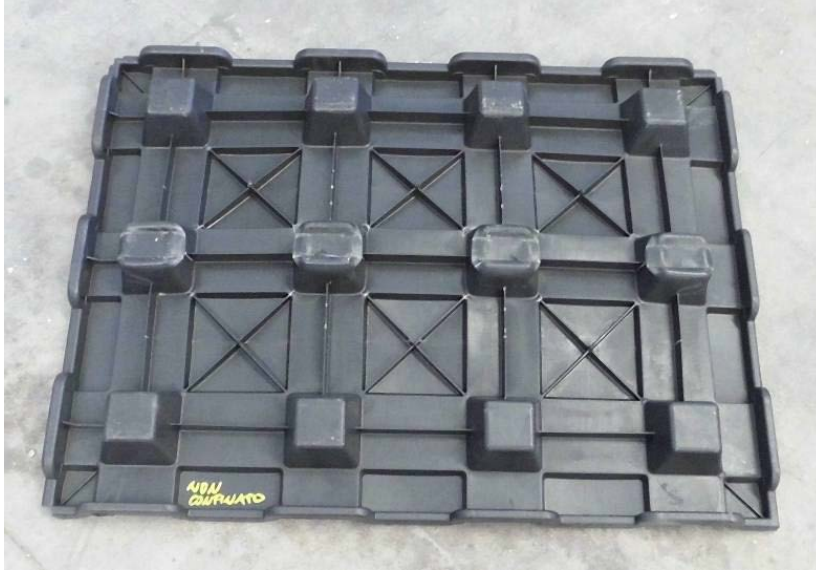
Resim 7: DEFENDER numunesi testinin sonunda kırılmış ürün detayı (serbest)
