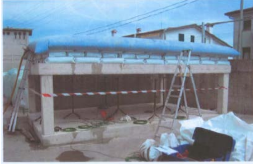
Zemin yükleme düzeneği (550 kg/m 2 'ye kadar)
