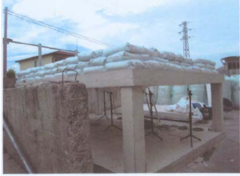
Zemin yükleme düzeneği (250 kg/m 2 'ye kadar)
